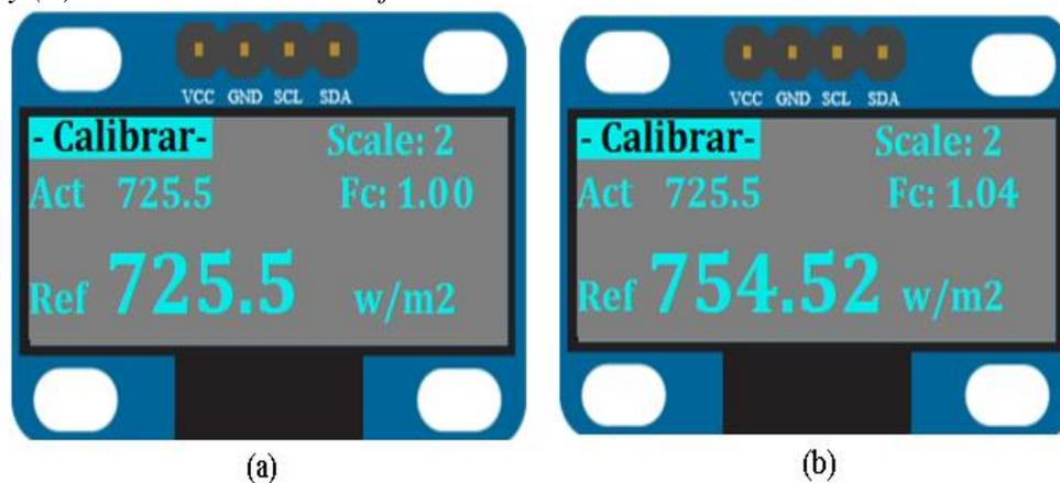
El segundo paso es el proceso de calibración del prototipo de piranómetro construido. Este proceso implica ajustar el factor de calibración como se evidencia en la figura 12(b) esto de manera manual hasta que las lecturas de irradiancia coincidan entre el piranómetro de referencia y el piranómetro que esto se realizó unos días antes de empezar con la calibración final, de preferencia al medio día.
