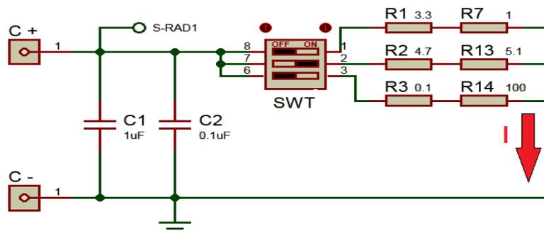
Para medir la irradiancia solar, se utiliza la corriente de cortocircuito de la celda, que es proporcional a esta. Por lo tanto, se conecta un circuito de filtrado selector de carga a los terminales de la celda como se aprecia en la figura 4, para poder realizar una medición de manera precisa y controlada.
