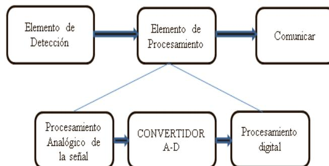
En el funcionamiento del prototipo se evidencian dos etapas bien marcadas en el diagrama de bloques de la figura 2: procesamiento analógico de la señal, conversión analógica a
