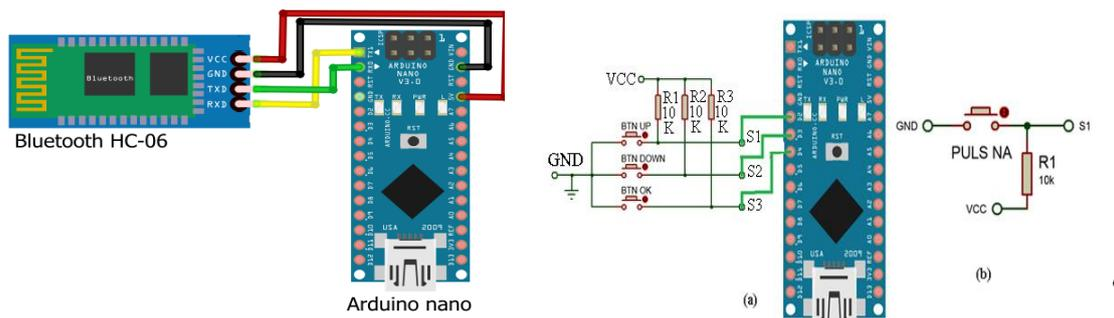
como se muestra la figura 9, mientras que el tercero es una entrada digital. Cada uno tiene una resistencia de 10kΩ.
