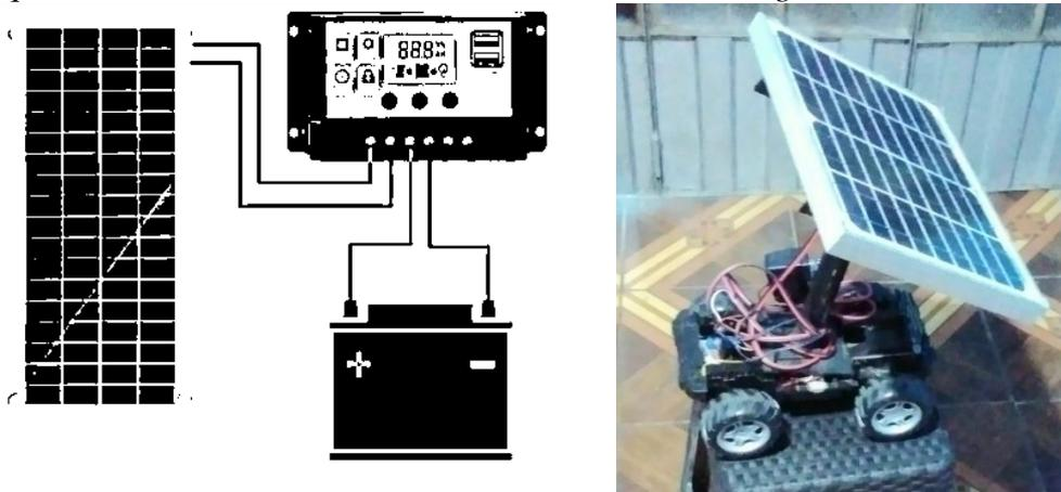
**Nota.** Foto tomada del vehículo en la fase de implementación de sistema fotovoltaico.
