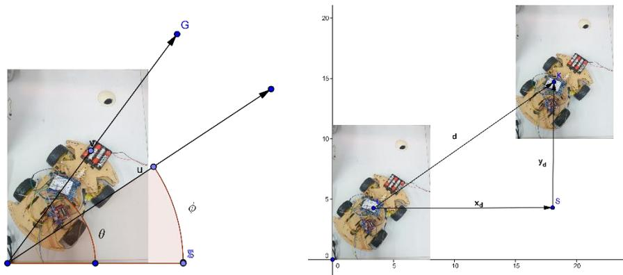
**Nota.** Foto tomada durante las pruebas de recorrido del vehículo en sistema de coordenadas “x” y “y”.
